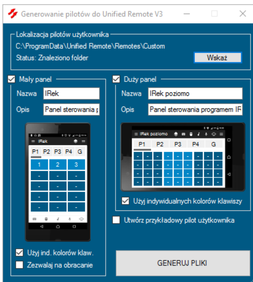
Rysunek 3.19 Okno generowania pilotów do programu „Unified Remote”
