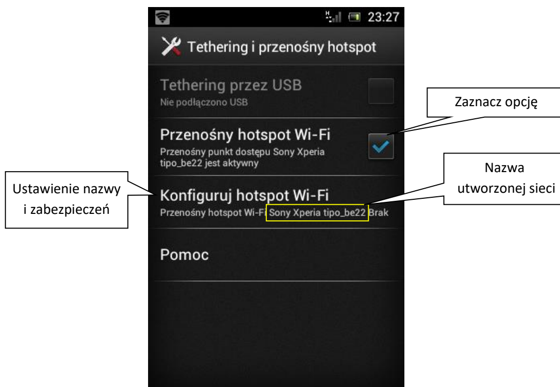
Rysunek 3.15 Włączenie opcji hotspot Wi-Fi
