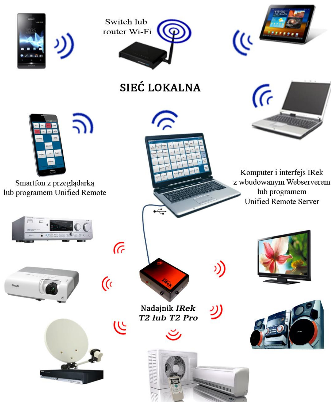
Rysunek 1.1 Schemat działania i możliwości systemu IRek
